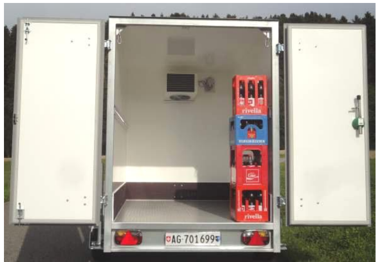
Innenansicht des Kühlaufbaus: mit 240 x 140 x 180 cm ist der Anhänger sehr geräumig
